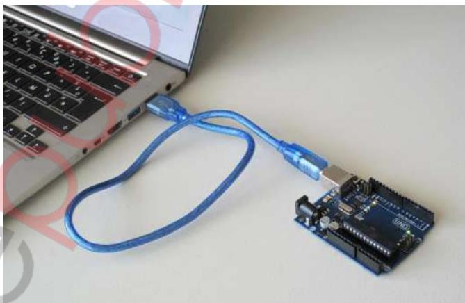
2. Cek pada bagian “Device Manager”. Apakah Arduino Uno *board* sudah dikenali atau belum. Jika belum lakukanlah instalasi *driver* sesuai jenis *chip* modul *USB to serial* yang dipakai.
